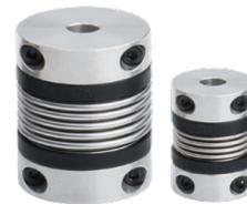
Metallbalgkupplungen für optimalen Verlagerungsausgleich. Wie empfohlen torsionssteife Metallbalgkupplungen, diese zeichnen sich durch eine außerordentlich hohe Verdrehsteifigkeit unter Drehmomentbelastung sowie durch sehr geringe Rückstellkräfte aus. Für einfache und sichere Montage/Demontage sind die Klemmnaben bis 10 N·m geteilt. Ab dem Messbereich 20 N·m können die Kupplungen Typ 8690 mit Passfeder eingesetzt werden.
