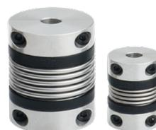
Metallbalgkupplungen für optimalen Verlagerungsausgleich. Für einen optimalen Verlagerungsausgleich empfehlen wir torsionssteife Metallbalgkupplungen. Diese zeichnen sich durch eine außerordentlich hohe Verdrehsteifigkeit unter Drehmomentbelastung sowie durch sehr geringe Rückstellkräfte aus. Für einfache und sichere Montage/Demontage sind die Klemmnaben geteilt.
