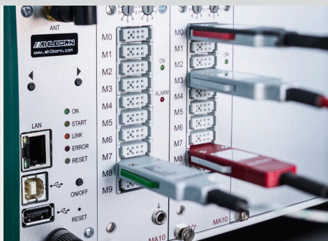
Porty czujników z wtykami ALMEMO® (wyświetlacz stanu OLED)
