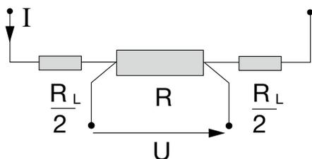
bei  $R = 1 \text{ m}\Omega \rightarrow R_L \leq 6 \text{ m}\Omega$
