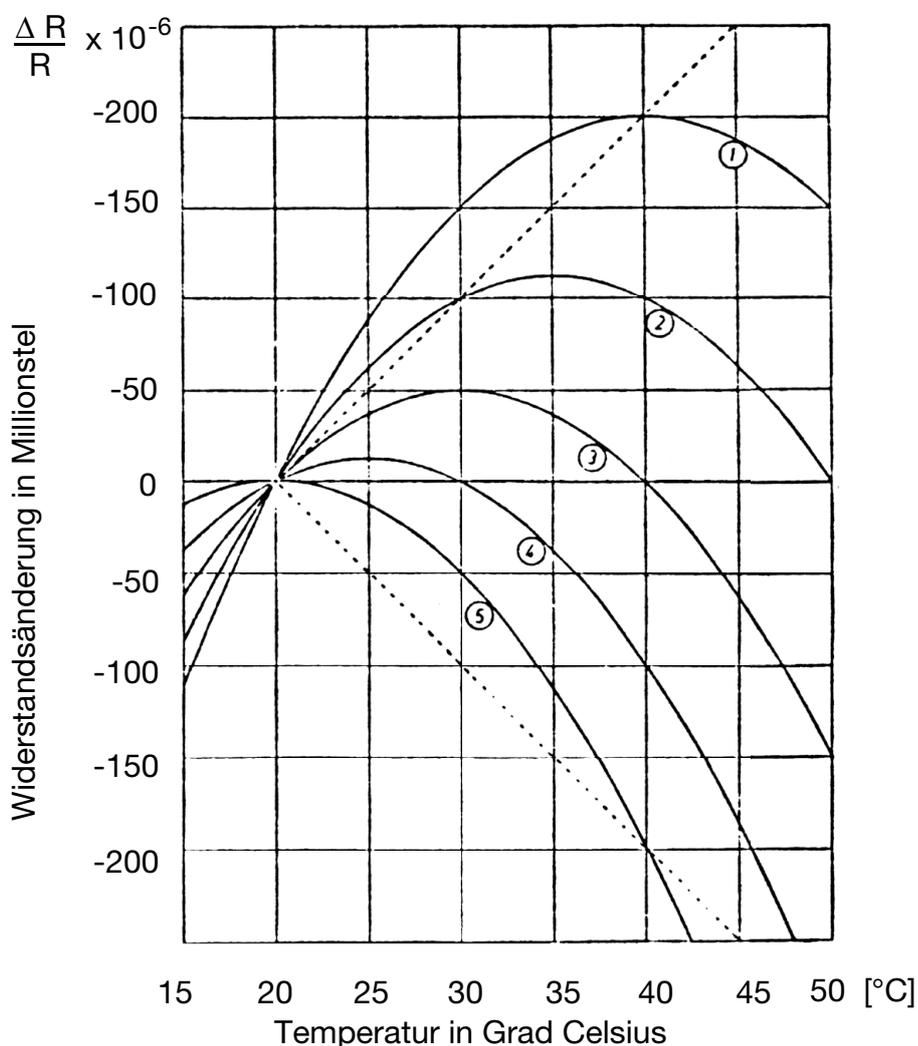
Die Abweichungen 1 ... 5 im Diagramm sind durch verschiedene Chargen (kleine Änderungen in der Legierungszusammensetzung bzw. in der Verarbeitung, wie z.B. verschiedene Abkühlgeschwindigkeiten) in der Materialherstellung bedingt.
