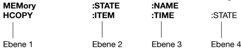
Die verschiedenen Befehlsebenen werden durch ":" getrennt. Manche Befehle haben optionale Befehlsköpfe. Zum Beispiel ist bei dem Befehl INITiate:IMMEDIATE der Befehlskopf aus Ebene 2 "IMMEDIATE" optional. Alle optionalen Befehlsköpfe müssen nicht mitgesendet werden.
