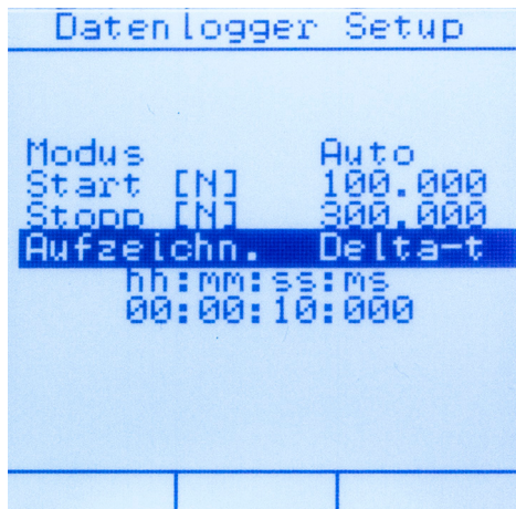
Abbildung 17: Datenlogger Setup „Delta-t“. Pro 10 Sekunden ein Messwert.
