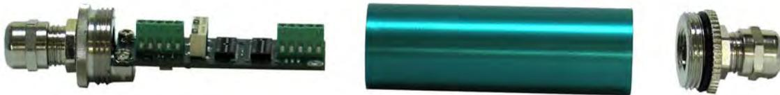
Abbildung 3: Sobald das Gehäuse von den Endstücken geschraubt ist, liegt die Platine offen.
